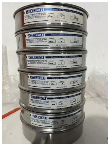
Figura 2 - Conjunto de peneiras granulométricas Solotest.
