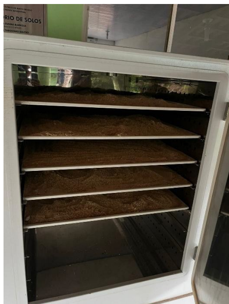
Figura 1 - Secagem controlada em estufa.
