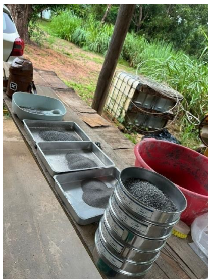
Figura 4 - Peneiramento do resíduo reciclado.
