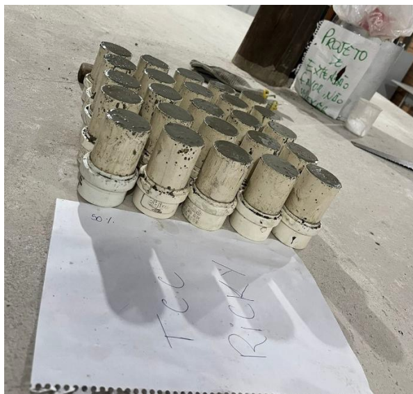
Figura 9 – Moldagem das amostras com 50% de substituição.
