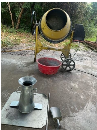
Figura 8 – Ensaio de abatimento pelo tronco de cone.
