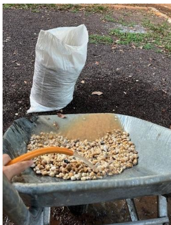
Figura 6 – Lavagem do agregado graúdo.
