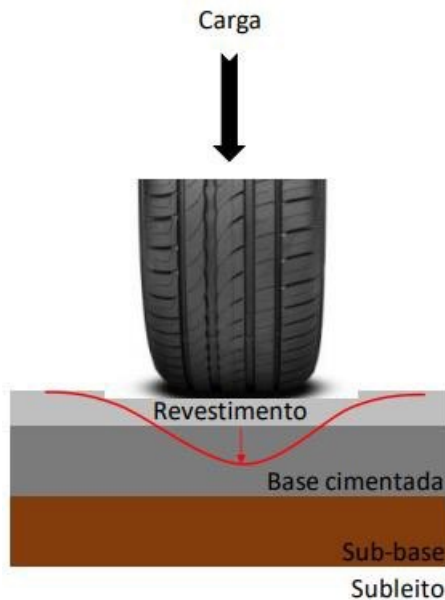
Figura 10 - Distribuição de tensões no pavimento semirrígido.
